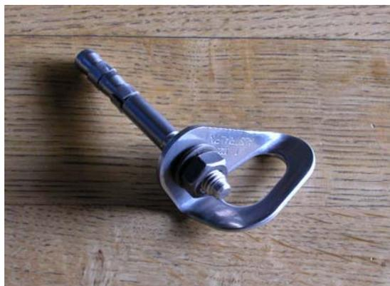
Expressanker sind die am meisten gesetzten Sicherungspunkte in der Schweiz. Nach dem Setzen sind sie sofort belastbar. Wird die Mutter mit dem empfohlenen Drehmoment angezogen, kann man sicher sein, dass der Anker genügende Lastwerte ( axial und radial ) erreicht.
